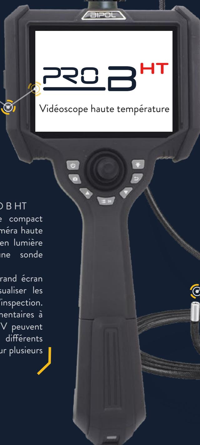
Le vidéoscope BIPOL PRO B HT est un système portable compact (0.6kg) composé d'une caméra haute résolution 720P éclairée en lumière blanche montée sur une sonde articulée 360°.
