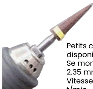
Petits cônes abrasifs corindon disponibles en plusieurs grains. Se montent sur un mandrin tige 2.35 mm. Vitesse recommandée 10.000 t/min
